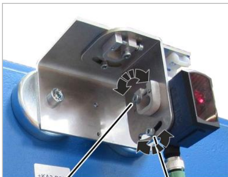
Vis à tête cylindrique pour le réglage fin Vis à tête cylindrique pour le réglage grossier
