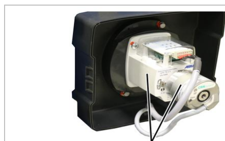
Vaihteiston rajakatkaisija "GPK" ja absoluuttikulma-anturi "Kübler"
