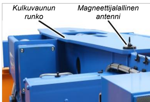
Esimerkki: magneettijalallinen antenni kulkuvaunun rungossa
