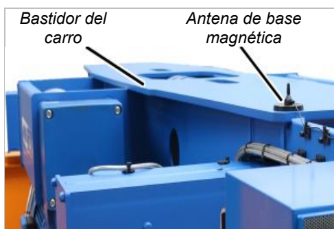
Ejemplo de antena de base magnética sobre bastidor del carro
