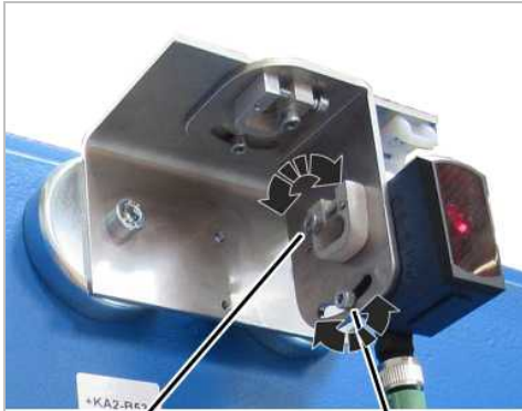
Zylinderschraube für die Feineinstellung Zylinderschraube für die Grobeinstellung
