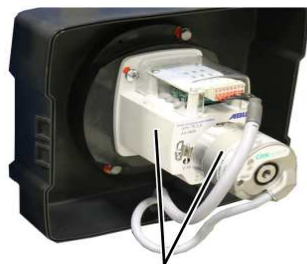
Getriebegrenzschalter ‚GPK‘ mit Absolutwert-Drehgeber ‚Kübler‘
