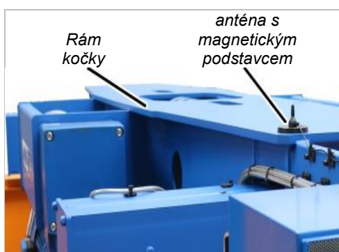
Příklad: anténa s magnetickým podstavcem na rámu kočky
