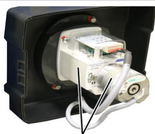
Limitador de curso da engrenagem "GPK" com encoder absoluto, "Kübler"
